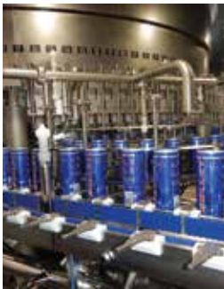
Chez KHS, c'est le bloc de remplissage et de sertissage de boîtes à haute performance SmartCan qui avait la vedette.
